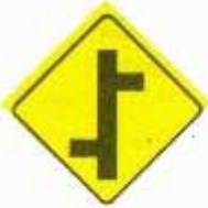
Empalmes contrarios sucesivos
